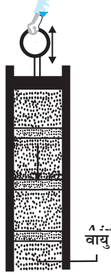
चित्र 15.4 पिस्टन को आगे-पीछे गति कराकर वायु से भरी नली में ध्वनि तरंग उत्पन्न की जाती है। चूँकि वायु-अवयव के दोलन तरंग गति की दिशा के समांतर हैं, अतः यह अनुदैर्घ्य तरंग है।
